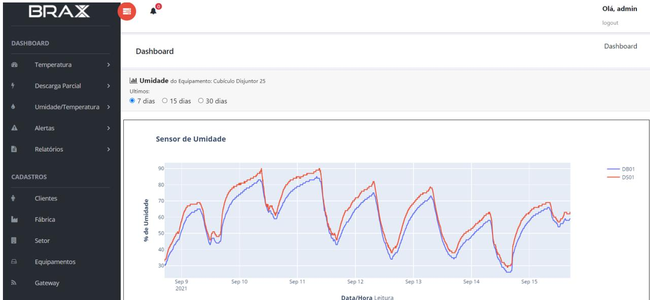
Figura 12 - Dados de monitoramento dos sensores de umidade no período de 7 dias.
