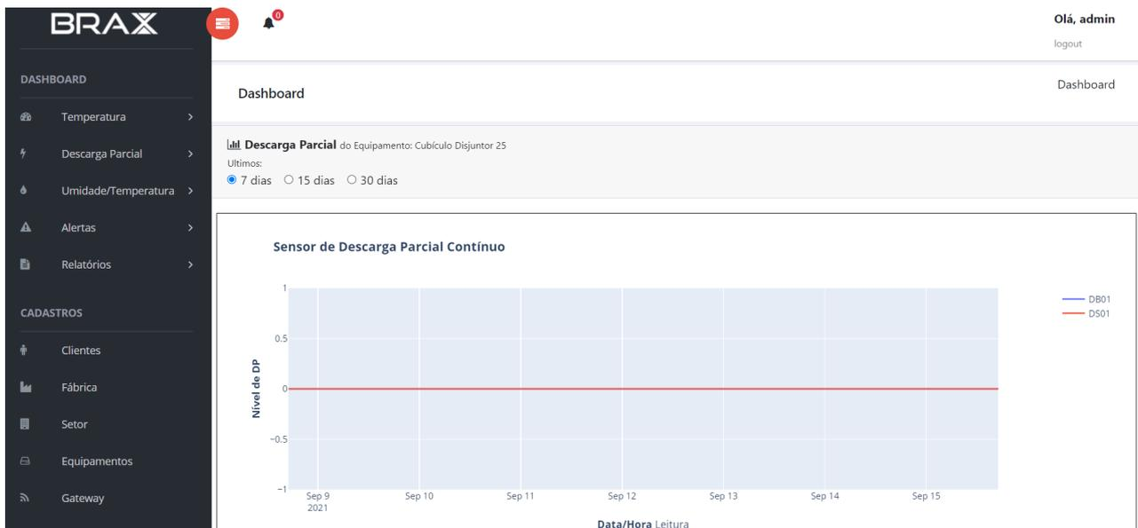
Figura 12 - Dados de monitoramento dos sensores de DPs no período de 7 dias.
