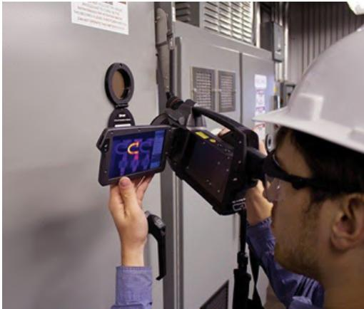
Figura 3 - Inspeção por imagens termográficas.
