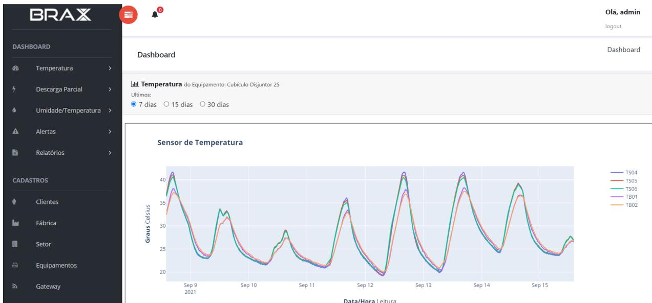
Figura 12 - Dados de monitoramento dos sensores de temperatura por contato no período de 7 dias.
