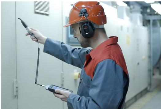
Figura 4 - Inspeção ultrassônica de DPs.
